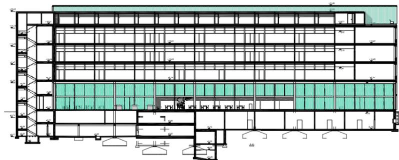
Die Anordnung der Kerne mit den Serviceräumen und den haustechnischen Anlagen bildet die Organisation der Grundrisse der Obergeschosse ab und spannt gleichsam die räumliche Gliederung des Erdgeschosses auf.
